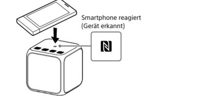
Befolgen Sie zum Herstellen der Verbindung die Anweisungen auf dem Bildschirm. Sobald die BLUETOOTH-Verbindung hergestellt wurde, leuchtet die Anzeige 📶 (BLUETOOTH) an diesem Gerät stetig. Zum Trennen der Verbindung halten Sie das Smartphone erneut an dieses Gerät.
