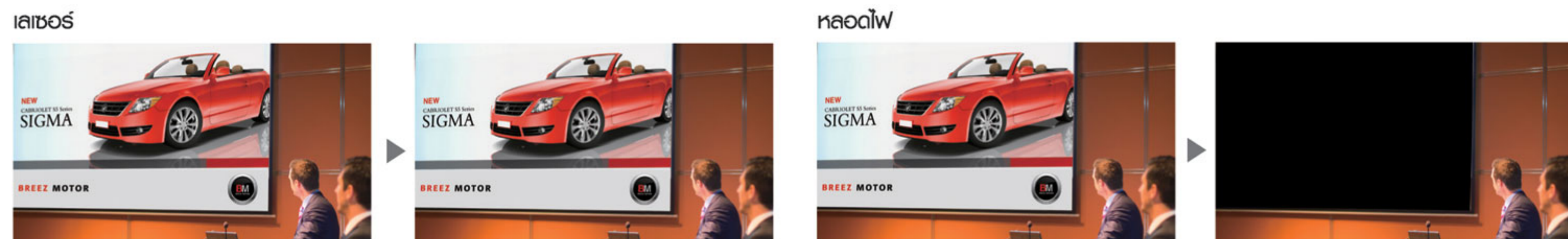
โปรเจ็กเตอร์ทำงานต่อเนื่องแม้ว่า light diode ชุดใดชุดหนึ่งเสีย
